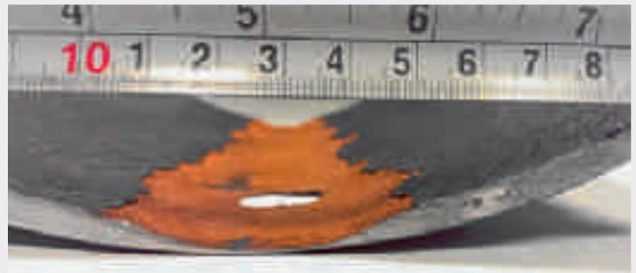
Fig. 5 Rohrdurchbrüche infolge Abrasion von Grobpartikeln im Sohlenbereich [4]
