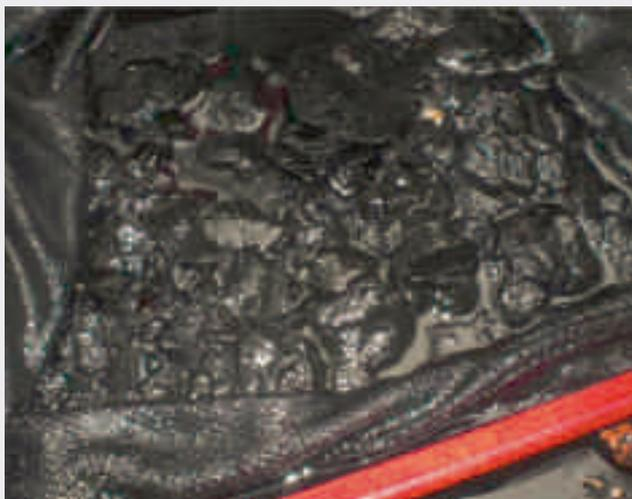
*Fig. 7* Gealterte Fettablagerungen aus Abwasserdruckleitung nach erfolgter Reinigung
