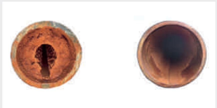
Fig. 9 Rohwasserleitung aus Asbestzement vor und nach der Reinigung
