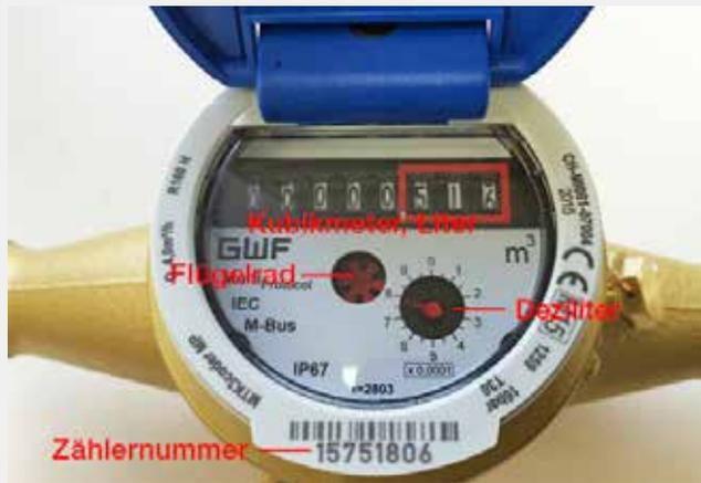
Ab 2014 eingesetzter Wasserzähler der Firma GWF mit Literauflösung
