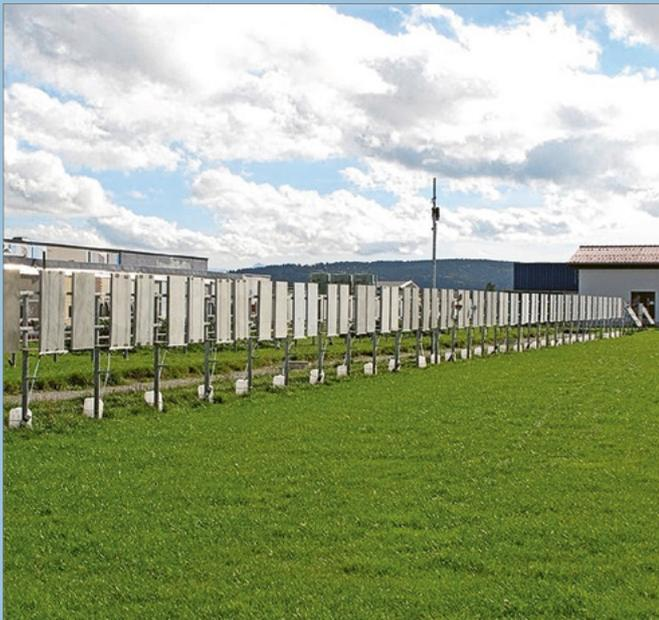
Bei der Freibewitterung werden Fassadenputze 18 Monate lang der Witterung ausgesetzt. Nach jedem Regenereignis werden die Proben im Labor untersucht. (Bild: ©Fraunhofer IBP)
