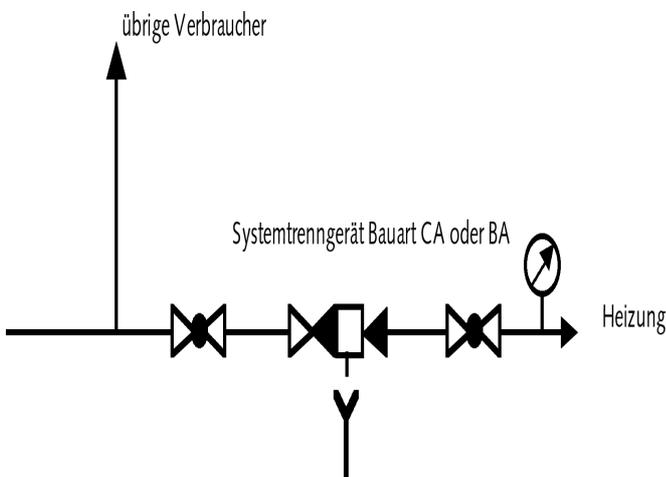
Mit Vorteil wird die Leitung so verlegt, dass das Systemtrenngerät direkt am T-Stück einer Verbraucherleitung ist. Dabei ist zu beachten,
